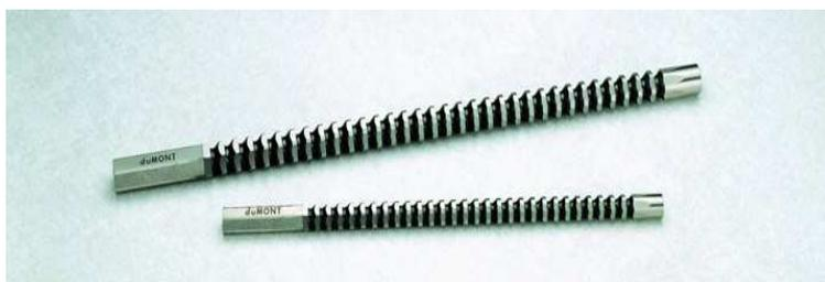
Le brocche a spinta per esagono sono realizzate per generare in un solo passaggio un foro esagonale in un foro tondo precedentemente realizzato.
